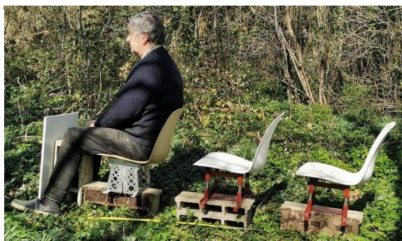
Test de dimensionnement – Remarquez le nouveau support de siège en aluminium coulé
