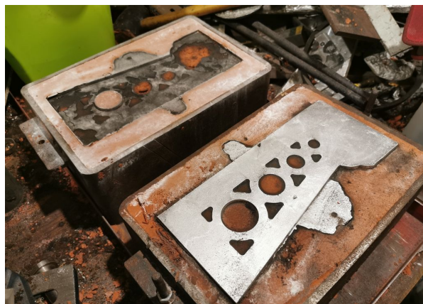
Test de dimensionnement – Remarquez le nouveau support de siège en aluminium coulé
